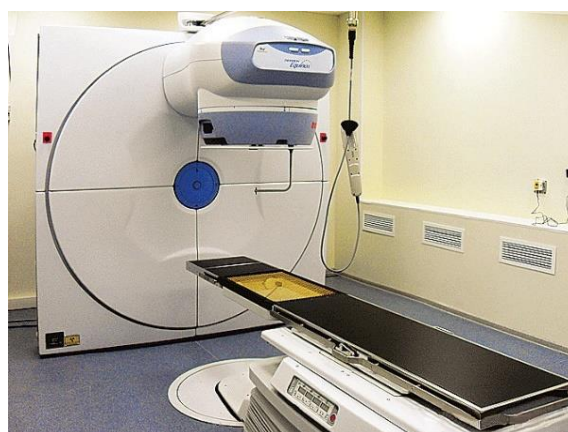
Рисунок 6 – Гамма-терапевтический аппарат Theratron Equinox
